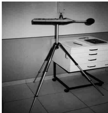
Figura 3 - Analisador de frequências imobilizado pelo tripé na altura do ouvido do pesquisador
