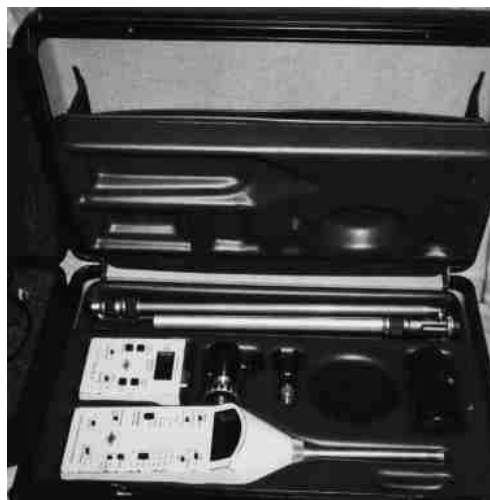
Figura 2 - Analisador de Frequência BRUEL & KJAER
